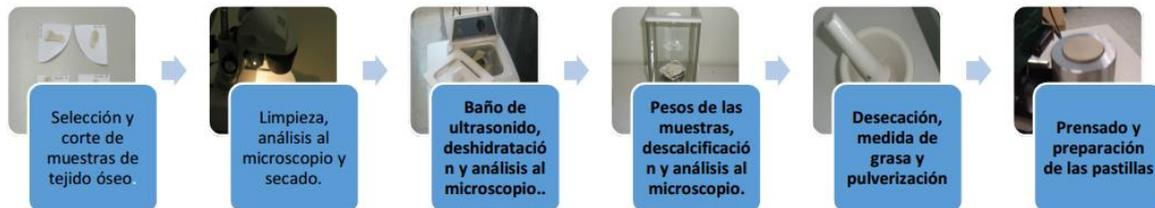
Figura 7. Diagrama en bloques del procedimiento para la preparación de muestras.
